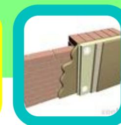
Wegen seiner geringen Gleichgewichtsfeuchte von ca. 5%, hält der Lehm, der das Holz umschließt, trocken und schützt es vor Pilzen und Insektenbefall. Tierische Schädlinge benötigen in der Regel eine Mindestfeuchte von 14 - 18 %, Pilze von mehr als 20%. Dadurch ist ein chemischer Holzschutz überflüssig und belastet weder Hausbewohner noch die ohnehin belastete Umwelt.
