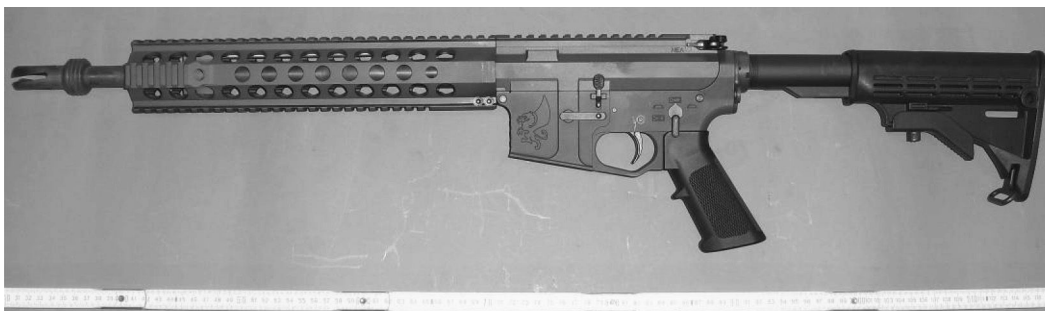
Abb. 1: NEA-15, Kal. .223 Rem. Ansicht linke Seite, Schulterstütze ausgezogen
